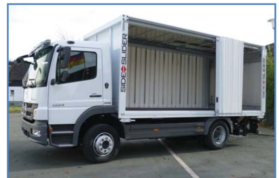
Minimaler Platzbedarf des Planenpaketes bei geöffnetem Aufbau
